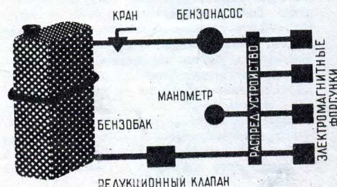
Рис. 2. Всасывание бензиновой смеси в цилиндр заменено впрыском.
